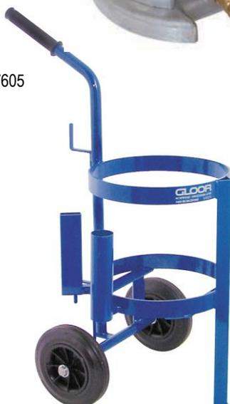
Propan-Flaschenboy, für 11 kg Propanflasche. Vollgummiräder Durchmesser 200 x 50 mm, Gesamtbreite 450 mm, blau gespritzt, mit Brennerhalter (Flüssig- oder Gasphase)
